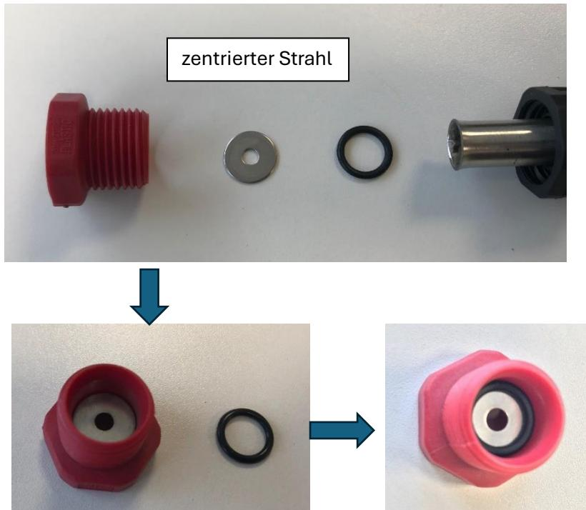
4. Schrauben Sie anschließend das rote Gehäuse wieder mit der schwarzen Überwurfmutter handfest zusammen.
