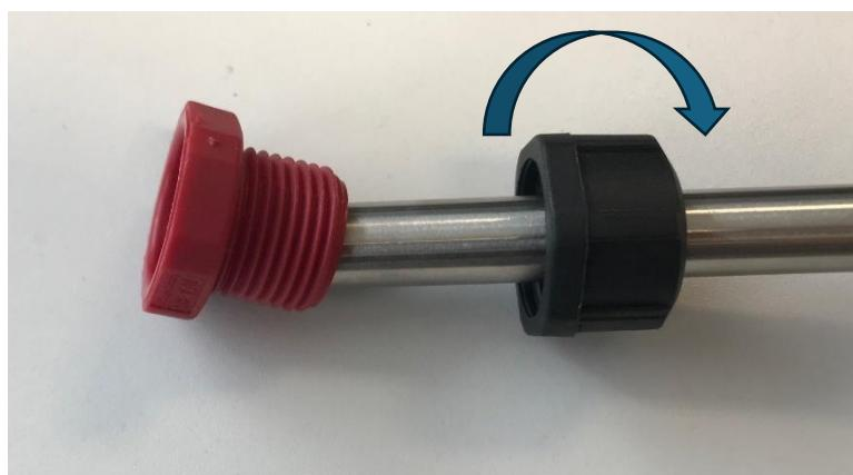
2. Entnehmen Sie den O-Ring, sowie den Düseneinsatz aus dem roten Gehäuse.
