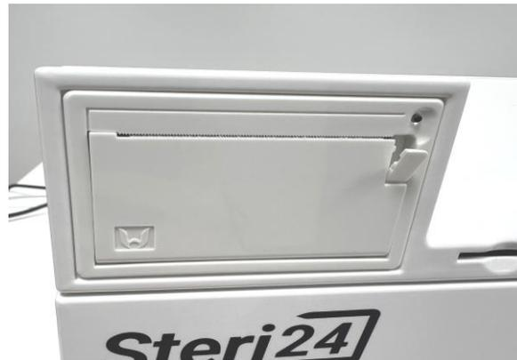
Ziehen Sie am Hebel um das Papierfach zu öffnen und wechseln Sie die Papierrolle. Schließen Sie daraufhin das Papierfach per Hand bis es hörbar einrastet.
